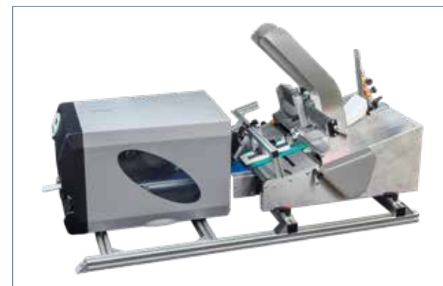
SOLID T4-2 intégré via GPIO dans un alimentateur à feuilles découpées
